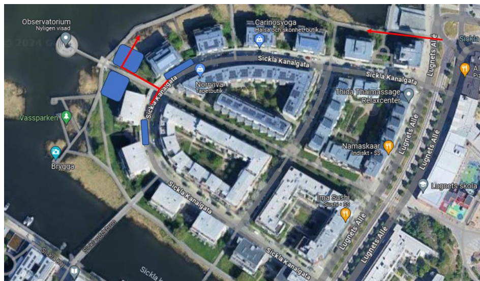
Figur 14. Röda pilar anger in- och utfart till arbetsområdet. Blå ytor anger förslag på etableringsytor.
